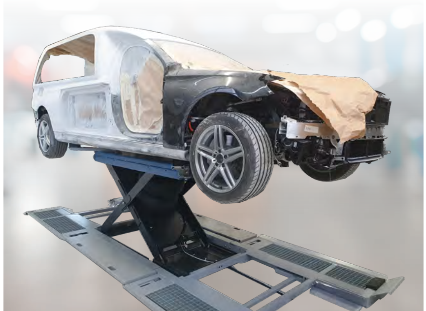
Herkules AirgoMatic BIG DUO-14 – auch lange Fahrzeuge können gehoben werden
