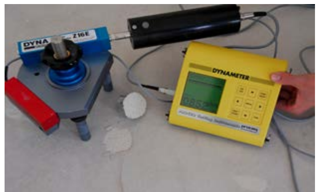
Haftzugprüfung mit Bruchbild und Stempel
