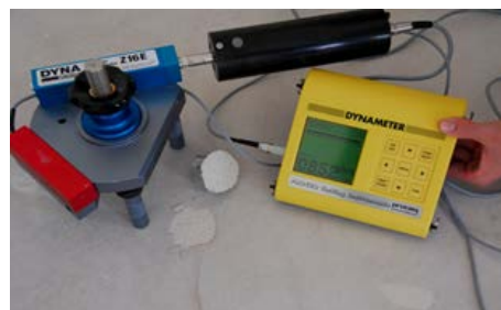
Haftzugprüfung mit Bruchbild und Stempel
